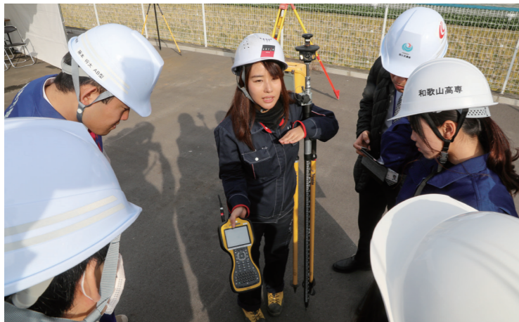
工事測量から丁張り、出来形観測まで、ワンマンで正確な測量が可能なTS測量も実機で体験。
