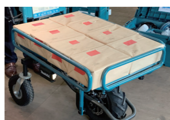
手で押す力をモーターがサポートする、バッテリー式運搬台車。
