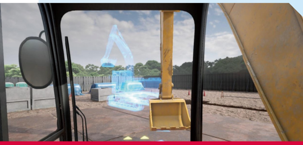
ディスプレイ解像度1600万画素に210度の視野角を搭載した「StarVR One」を使用。VR映像内のCGにもこだわり、機械のちょっとした錆など「使い込んだ」リアル感まで表現。動きの面でもスピードや角度の実験・検証を行い現実に即したものに仕上げた。
