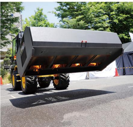
屋外会場に展示された路面乾燥車は、従来型の直火タイプ(バーナー1本で900°C)とは異なり、バーナーの熱を送風機で送り路面を乾かす熱風タイプ。路面を傷める心配なく、冬季の道路工事で雪や氷を溶かしたり、濡れた路面を乾燥させることができる。また4基のバーナーは独立制御が可能で、両端の2基、いずれか1基といった使用も可能だ。夏季はさらに高架での舗装工事を行う際の下地処理として、防水シートを乾かす際にも有効だ。
