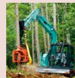
0.25㎡ハーベスタ高性能林業機 械による伐倒作業。
