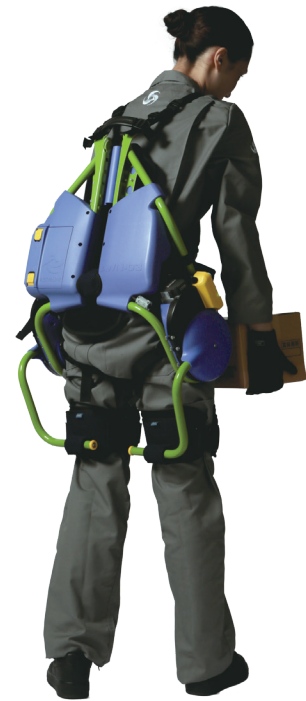
寸法:全長 480×全幅 270×全高 770mm 質量:6.7kg(充電池除く)
